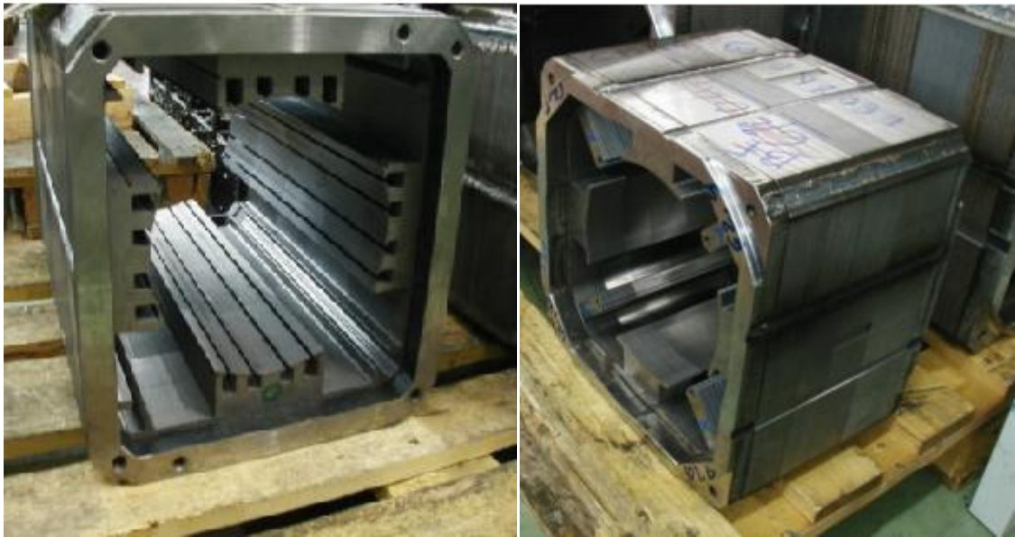
Figure II.1 Culasse, circuit magnétique statorique d'une machine à courant continu.
