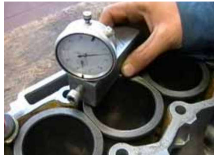
Mesure du dépassement des chemises
