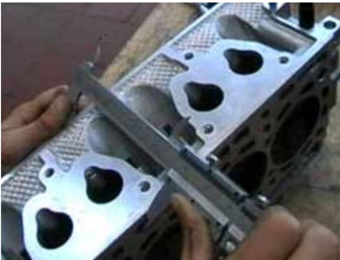
Vérification des dimensions du bloc Moteur
