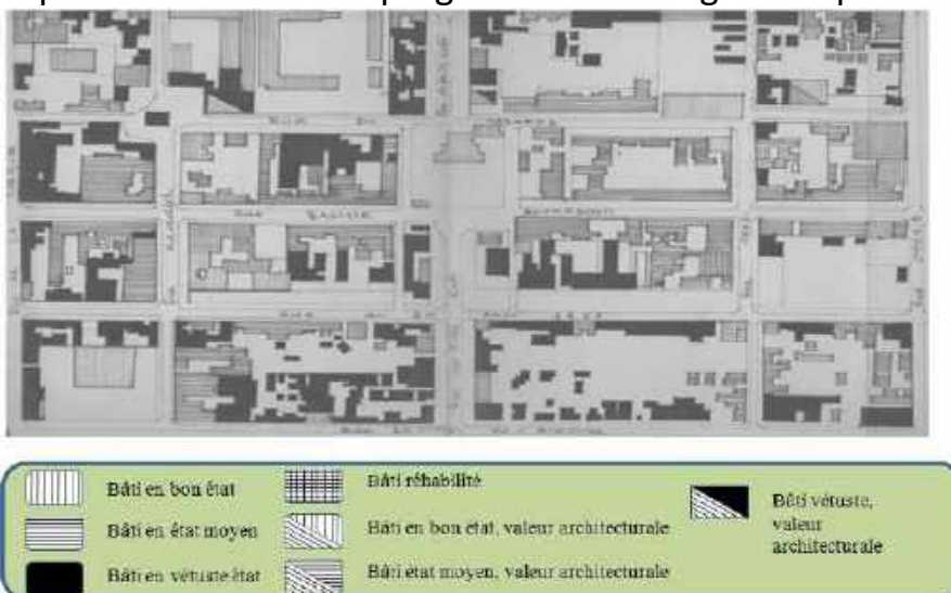
Figure 8. Etat du bâti du centre colonial d'El Harrouch en 1987. Echelle 1/2000. Source: ZEHIOUA HECHAM BERNIA. 1987
