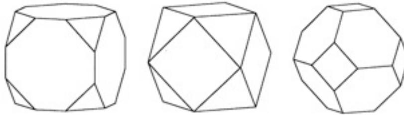
*Trois aspects différents de la pyrite. Les contours et l'importance du développement des faces a et b sont différents d'un exemple à l'autre. Toutefois leur orientation réciproque est constante et l'angle qu'elles font entre elles est de  $54^{\circ} 44'$ .*
