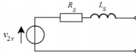
**A.9** Dans l'essai en court-circuit, comme les pertes ferromagnétiques sont négligeables, la puissance active  $P_{1c}$  appelée par le transformateur est égale aux pertes par effet Joule qui correspondent à trois fois la puissance dissipée dans la résistance  $R_S$  du schéma monophasé équivalent :
