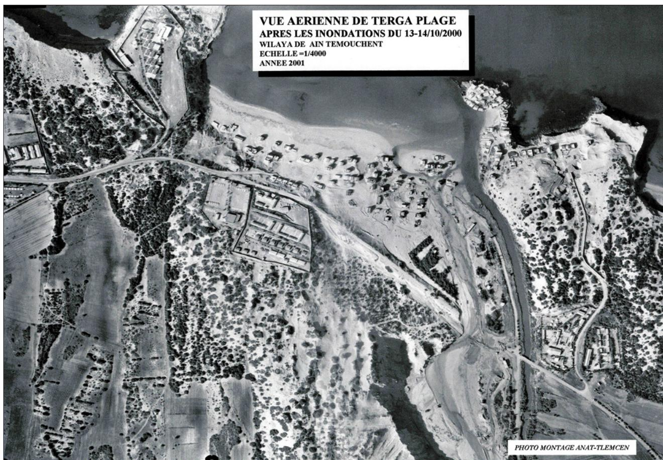
**Photo 4** – Montage d'un ensemble de vues aériennes par l'ANAT (2002) prises quelques jours après les inondations des 13 et 14 octobre 2000. À droite de l'image, nous remarquons l'élargissement de l'oued El Maleh due à l'extension de la sablière, les cabanons de la partie nord de la plage sont envahis par les débordements de l'oued sur les zones proches de sa rive gauche – Cliché INC, (2000). Wilaya de Ain Temouchent. Échelle 1/4000.
