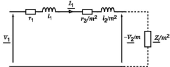
**Figure I. 9** Simplification du circuit équivalent
