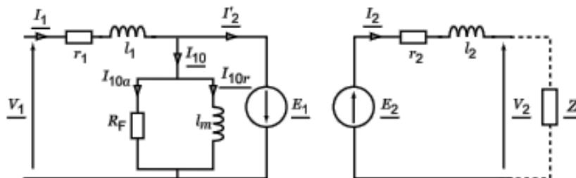
**Figure I.7** Circuit équivalent du transformateur monophasé réel en charge.
