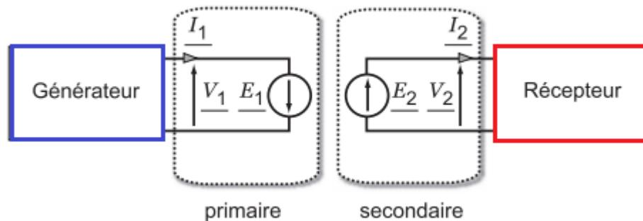
**Figure I.2** Constitution d'un transformateur
