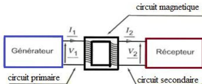
**Figure I.1** Constitution d'un transformateur
