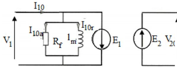
**Figure I.6** Circuit équivalent du transformateur réel à vide
