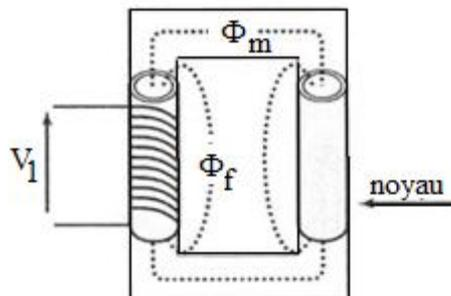
**Figure I. 5** Fuites de flux dans un noyau
