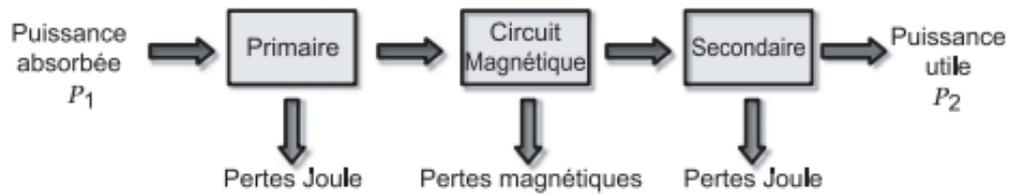
**Figure I.11** Chaîne des pertes dans un transformateur.
