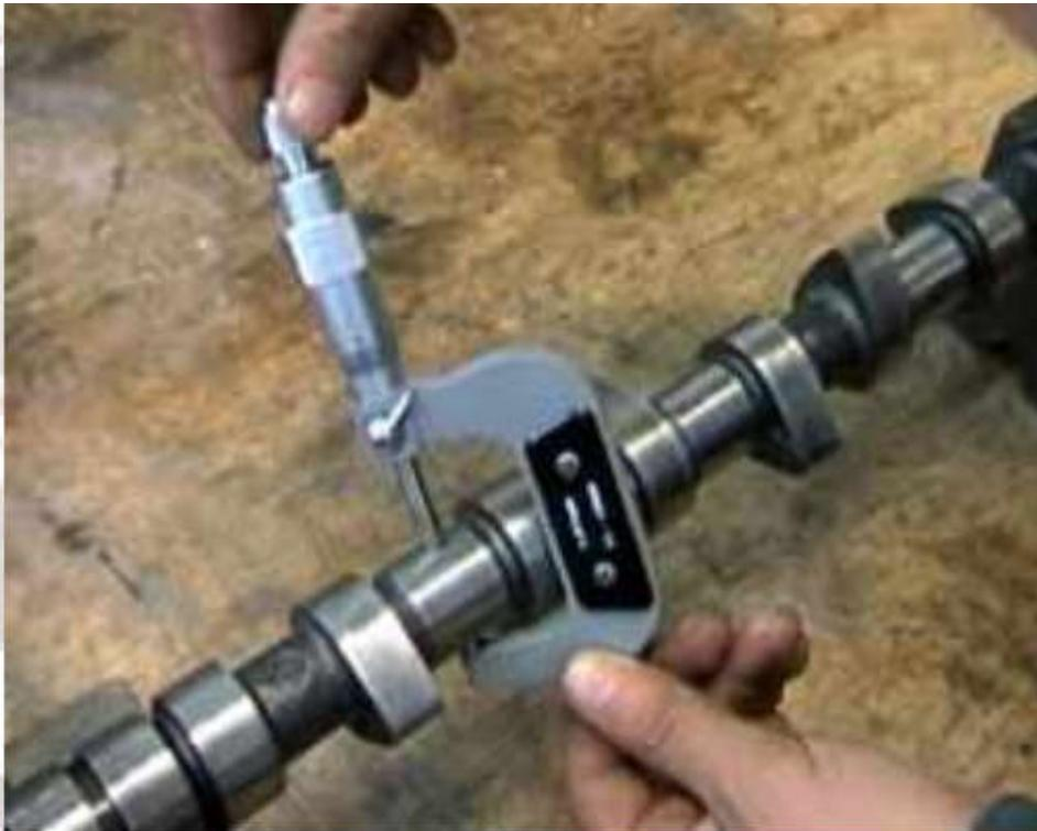
Mesure du diamètre de palier d'arbre à cames
