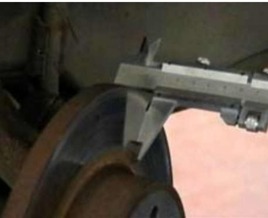
Mesure de l'épaisseur des disques de frein
