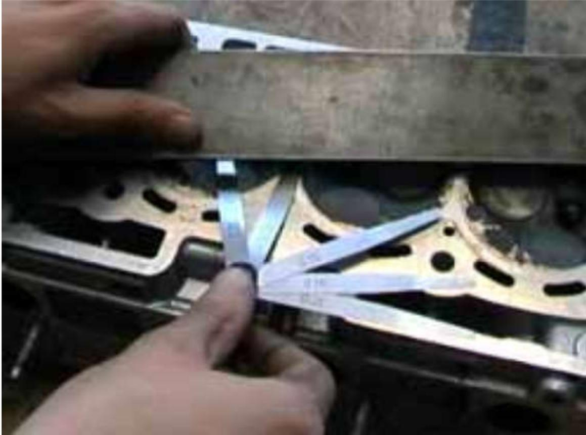
**Contrôle de la planéité de la culasse**
