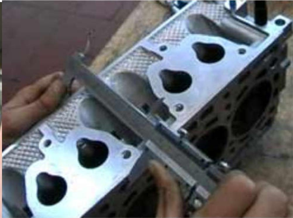
Vérification des dimensions du bloc Moteur
